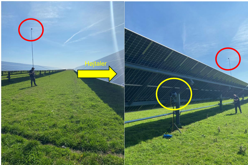
Figur 4. Eksempel på placering af målepositioner i 5 m højde. Måleposition 180 grader (til venstre) og 90 grader (til højre). Målepositionerne er markeret i rødt og højtaleren er markeret med gul.
